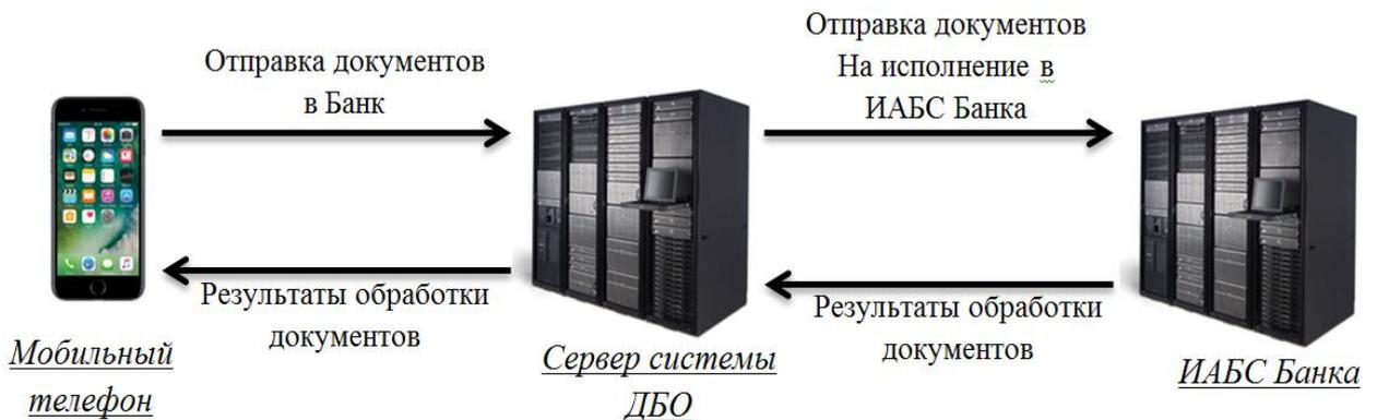
Рис. 1. Схема взаимодействия мобильного телефона удаленного клиента с ИАБС Банка
